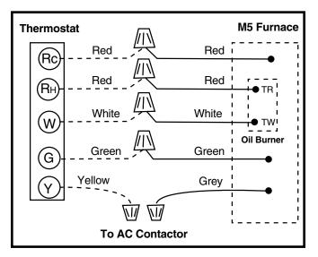
Figure 25. Thermostat Wiring
